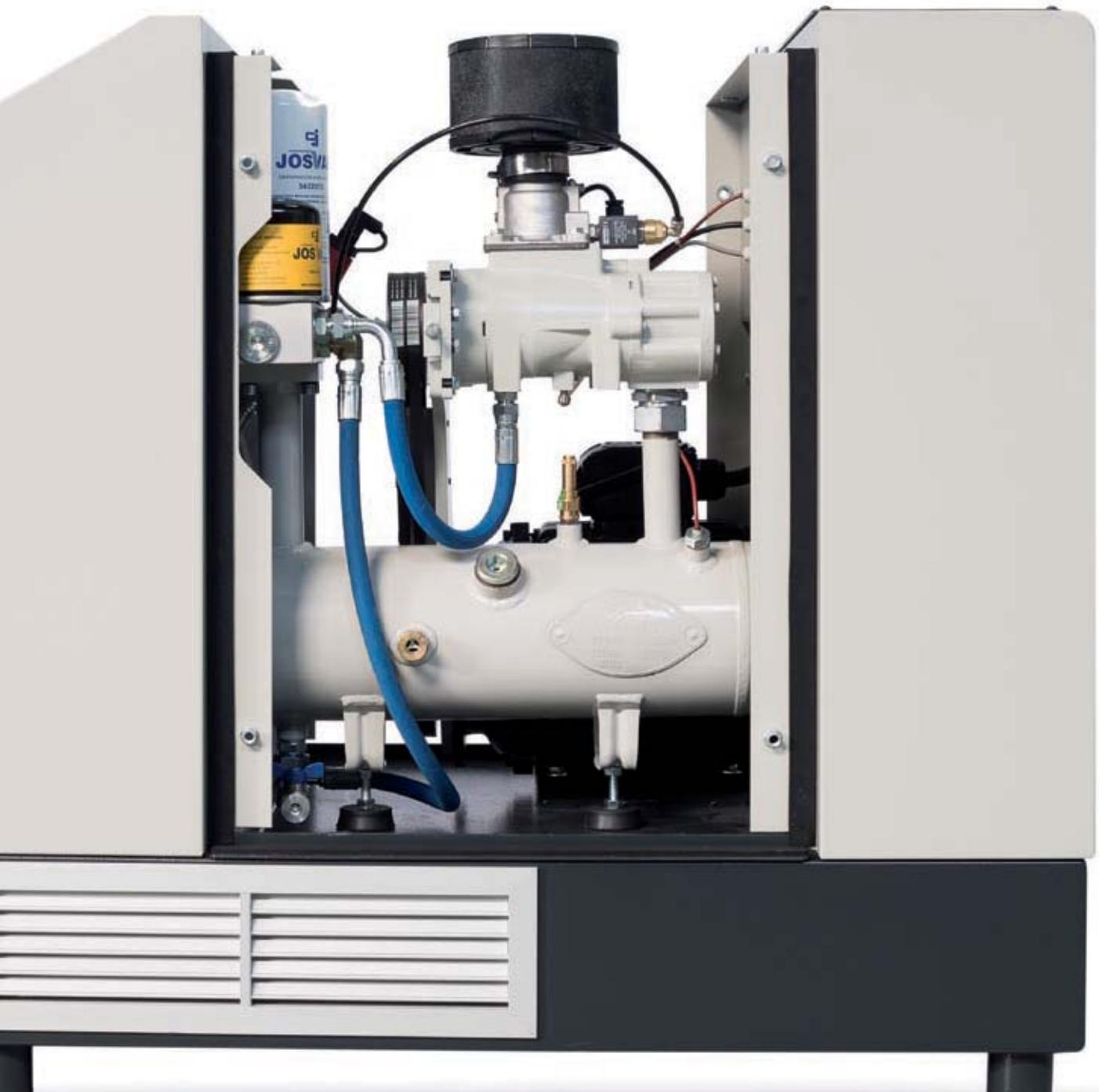
Los compresores rotativos de la serie MISTRAL, incorporan un bloque rotor de una etapa con tornillos asimétricos montados sobre rodamientos. Su accionamiento se realiza mediante un motor eléctrico trifásico asíncrono con protección IP 55/F-B, a través de correas trapezoidales. Este sistema de transmisión ofrece gran fiabilidad y bajo nivel sonoro.
