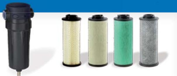
**FEP:** Filtros adecuados para la eliminación de partículas sólidas hasta 5 micras, incluidos líquidos, emulsiones y partículas de aceite. Su fuerte resistencia mecánica hace que estos filtros sean la protección inicial ideal para el principio de una instalación de aire comprimido y poder así retener las impurezas. Por ejemplo, se recomienda su instalación a la entrada de los secadores para hacer de prefiltro a los modelos FES.
