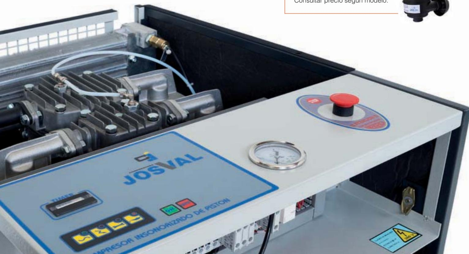
En caso de instalación completa de compresor con tratamiento de aire, el equipo constaría de compresor MONCAYO, depósito acumulador, secador frigorífico de la serie EDS y filtro separador de partículas de la serie FEP.
